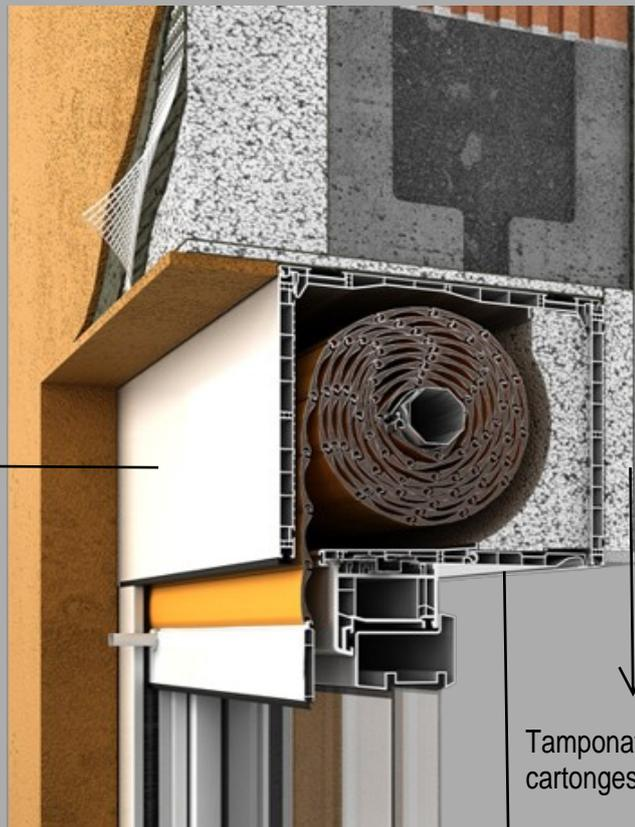
Tamponatura con intonaco o cartongesso-fibrocemento
