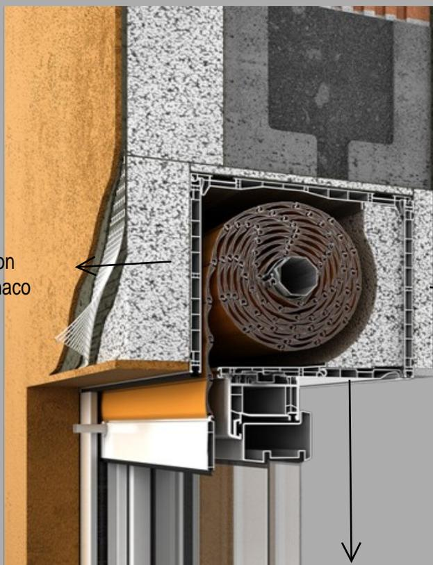
Tamponatura con intonaco o cartongesso-fibrocemento
